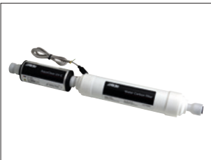
"Vedenpuhdistus" – Alde AquaClear UV-C (lämmittimeen Alde Compact 3030). Tehokas vedenpuhdistus suojaa käyttäjän terveyttä kuin huomaamatta ja ympäristöystävällisesti. Järjestelmä poistaa vedestä haitalliset virukset ja bakteerit, torjunta-aineet ja kemikaalit. Vesi desinfioidaan valodiodien tuottamalla UVC-valolla. Vesi kulkee myös hiilisuodattimen läpi, minkä jälkeen vesi on hajutonta, mautonta ja väritöntä.
