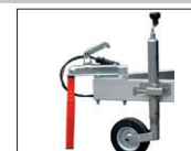
Aisavaaka. Kuormaa vauna tasaisesti ja punnitse aisapaino, niin ajoneuvoyhdistelmä pysyy vakana. 09990
