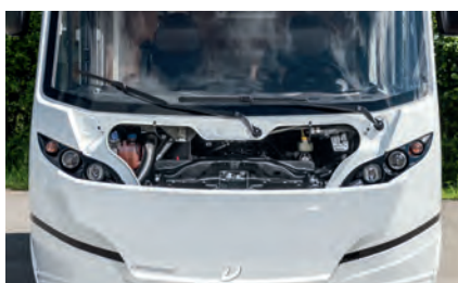
» I: Kaikki helposti käsillä: iso moottoritilan huoltoluukku helpottaa huoltoa
