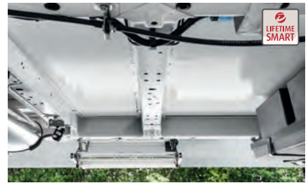
» Puuvapaa, kosteutta hyvin kestävä Lifetime-Smart-lattiarakenne (lasikuituinen alapohja)
