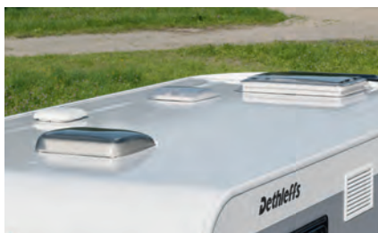
» Kestävä lasikuitukatto suojaa raekuuroilta
