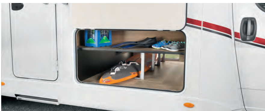
» A 7877-2: Korkea kaksoispohja on lastattavissa auton molemmilta puolilta. Lisäksi se suojaa autosi tekniikkaa ja vesijärjestelmiä pakkaselta.
