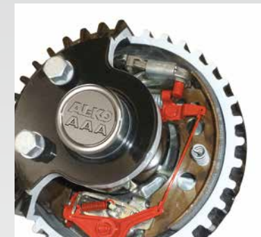
+ Automaattisesti säätävät AL-KO AAA -jarrut optimoivat jarrutuksen
