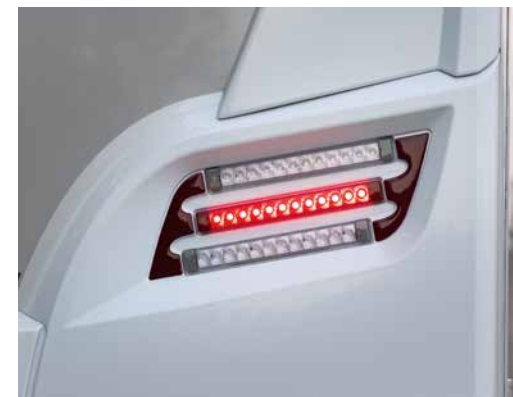
+ Useampiosainen, LED-takavaloin varustettu takapuskuri on helppo korjata
