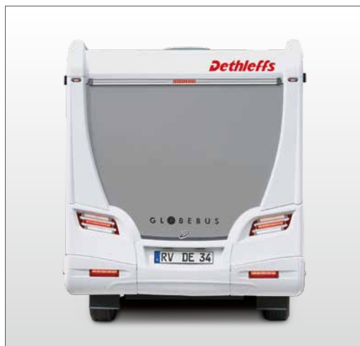
+ Useampiosainen, LED-takavaloin varustettu takapuskuri on helppo korjata
