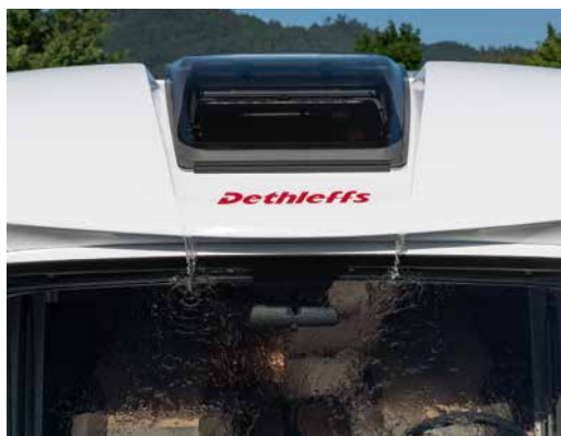
+ Hyvin suunniteltu vedenohjausjärjestelmä ohjaa sadeveden tuulilasiin ja taaksepäin
