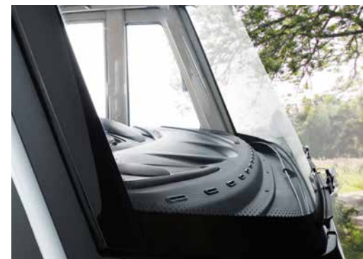
+ Tuulilasi pysyy kuivana ja huurteettomana kojelaudan ilmankiertokanavasta johdetun lämpimän ilman ansiosta
