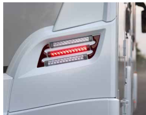
+ Useampiosainen, LED-takavaloin varustettu takapuskuri on helppo korjata
