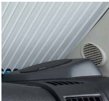
+ Radiolle asennuspaikka, kovaääniset, kaapeliliitännät ja antenni valmiina
