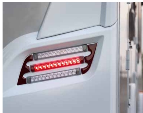
+ Useampiosainen, LED-takavaloin varustettu takapuskuri on helppo korjata
