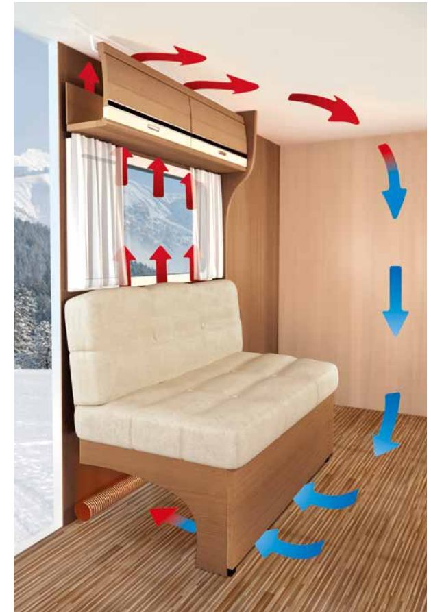
+ Hyvä sisäilma: AirPlus-järjestelmä, jossa ilma kiertää kalusteiden ja yläkaappien takaa, estää kondenssiveden muodostumista
